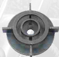
Schleuderrad mit 4 Schaufeln blast wheel with 4 blades
